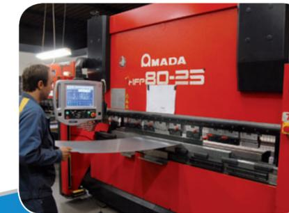
**1 Plieuse** : 9 axes, 100 tonnes
